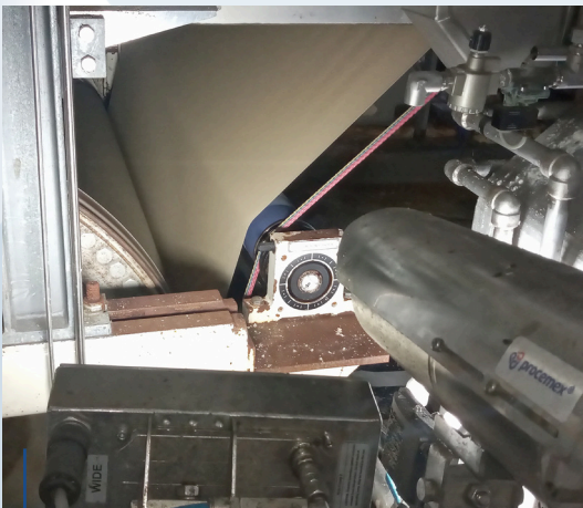
• FÁBRICA DE PAPEL, CHILE. Sistema de monitoreo de hoja.
